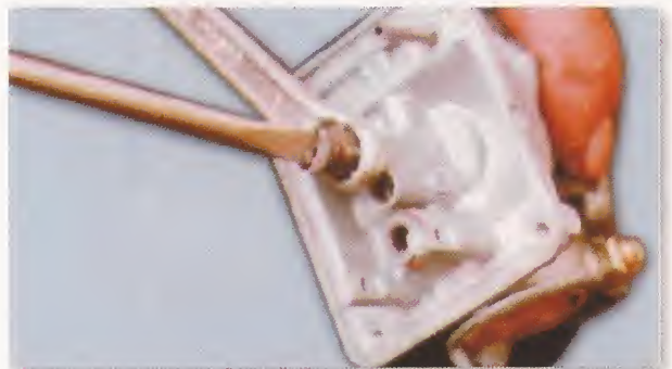
Retiro del boquerel principal
